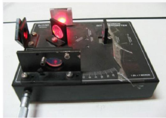
Hình 4. Thiết bị thí nghiệm giao thoa kế Michelson
